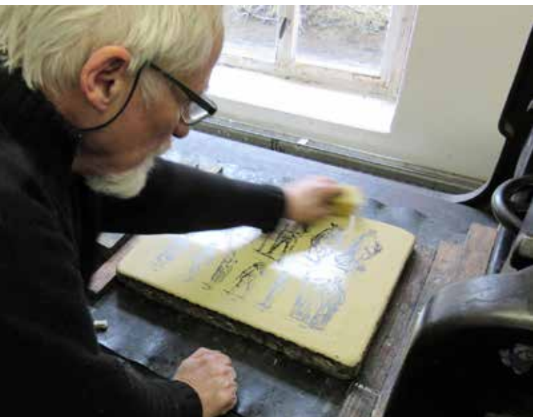
Der Litho-Stein wird angefeuchtet
